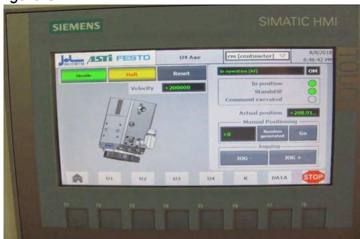
b- Ecranul HMI pentru comanda și controlul sistemului MMI4D
