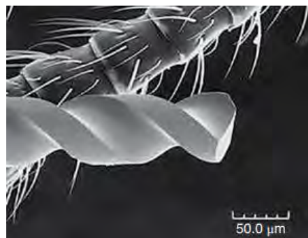
Figura 2.7: Exemple de piese microprelucrate abraziv cu jet de apă
