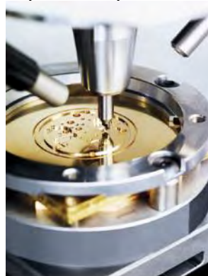
Figura 2.5: Microfabricația de componente pentru ceas
