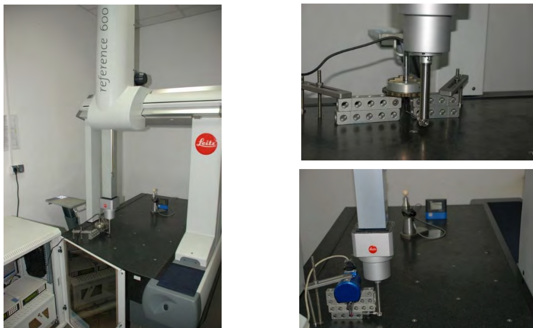
Figura 3.2: Echipament pentru măsurare, calibrare și testare în 3D -Leitz
