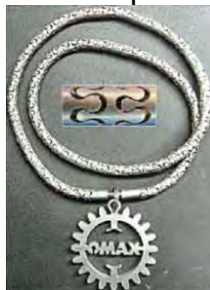
Figura 2.7: Exemple de piese microprelucrate abraziv cu jet de apă
