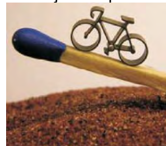
Figura 2.7: Exemple de piese microprelucrate abraziv cu jet de apă
