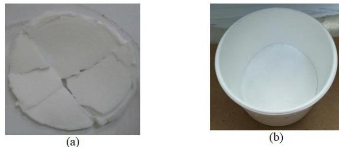
**Figura 5:** (a) CHAp înainte de calcinare; (b) CHAp după calcinare
