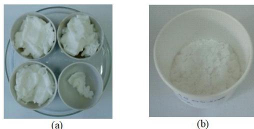
**Figura 7:** (a) Ag-CHAp înainte de calcinare; (b) Ag-CHAp după calcinare
