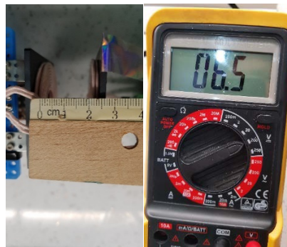
Fig. 95 Distanța de 2,2 cm dintre bobinele Tx și Rx și valoarea tensiunii de ieșire la modulul Rx
