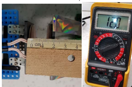
Fig. 93 Distanța de 1,5 cm dintre bobinele Tx și Rx și valoarea tensiunii de ieșire la modulul Rx
