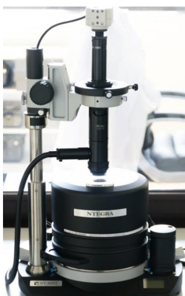
Figura 3.9. Microscop cu forță atomică aflat în dotarea laboratorului de caracterizarea materialelor din cadrul institutului de cercetare al Universității Valahia din Târgoviște
