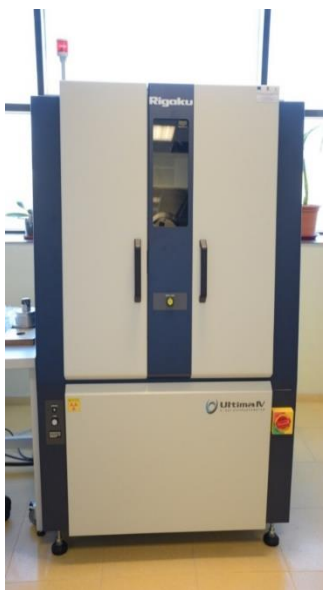
Figura 3.3. Difractometrul de raze X din dotarea laboratorului de caracterizarea materialelor din cadrul institutului de cercetare al Universității Valahia din Târgoviște
